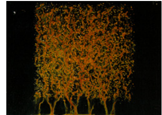
Zinkphosphat + 50-60 µm Pulverlack nach 144 h
