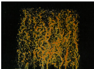
Zinkphosphat + > 80 µm Pulverlack nach 144 h
