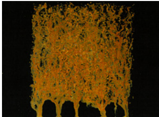
Zinkphosphat + 12 µm KTL nach 144 h
